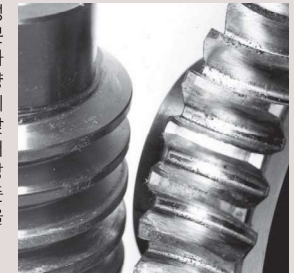
치면강도 부족에 의한 마모 예
