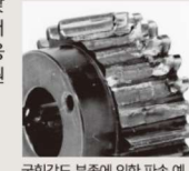
굽힘강도 부족에 의한 파손 예
