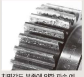
치면강도 부족에 의한 파손 예
