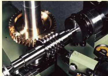
KLINGELNBERG公司制造的蜗杆蜗轮啮合检测仪
