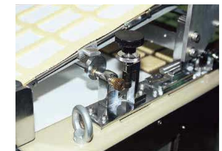
使用 SW 蜗杆和 BG 蜗轮调整输送布料的高度
