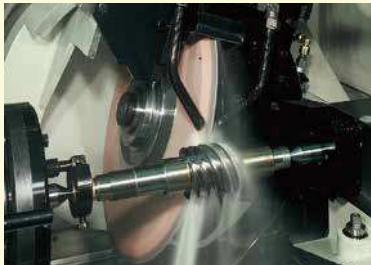
KLINGELNBERG公司制造的蜗杆磨削机
