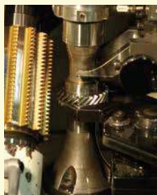
使用滚床对交错轴斜齿轮切齿加工
