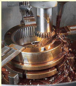
使用 CNC 插齿机加工内齿轮轮齿
