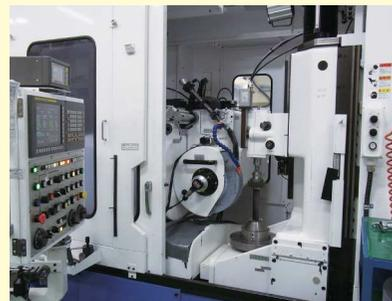
REISHAUER 公司制圆柱齿轮磨削床 (RZ701)
