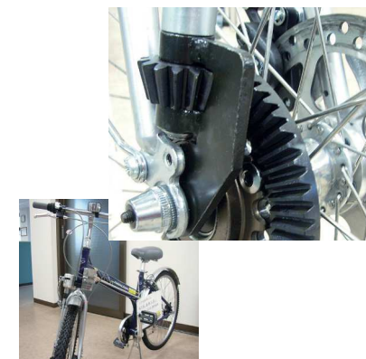
SHESCO 公司制造 FULL TIME 2WDBIKE 的后轮驱动部使用了 SB 系列锥齿轮
